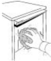
Pour le nettoyage de la carrosserie il suffit de passer sur les surfaces un chiffon trempé avec un produit spécifique sans chlorine pour acier inox.
