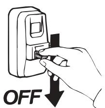
Dopo ogni ri-avviamento, sia ad interruttore esterno che tramite gli automatismi interni, la macchina si metterà in funzione sempre dopo i 3 minuti di ritardo (4° LED lampeggiante).
