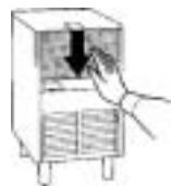
Pidä säiliön ovi suljettuna.
