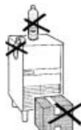
Eviter de poser sur ou autour de l'appareil toute sorte d'objets, qui peuvent causer une mauvaise ventilation et un manque d'hygiène.
