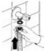
Placer correctement les tuyaux d'écoulement dans la vidange.
