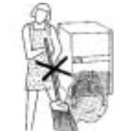
Se till att fläktmotorn inte suger in damm i ismaskinen i samband med att golvet intill maskinen rengörs.
