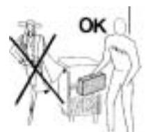
Løft ismaskinen, hvis den skal flyttes, så benene ikke beskadiges.
