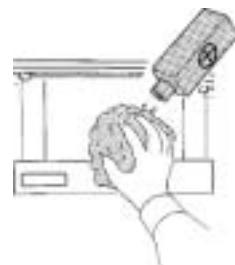
Voordat de machine de eerste produktie van ijsblokjes heeft "gelost" dient de voorraadbunker met een **NIET-AGRESSIEVE DESINFECTANT** te worden gereinigd.
