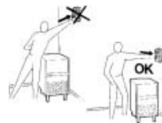
Strömbrytaren till ismaskinen måste finnas inom räckhåll från maskinen.
