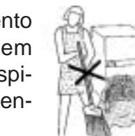
Durante a limpeza do pavimento junto da máquina tenha em atenção que a poeira não é aspirada a unidade por meio de ventoinha do motor.
