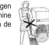
Pas er voor op dat tijdens het vegen van de vloer rondom de machine geen stop door de ventilator van de machine wordt opgezogen.
