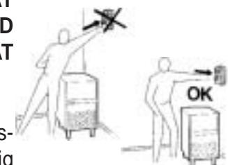
De elektrische voedings-schakelaar dient 2-polig en onder handbereik bij de te installeren machine te zijn.
