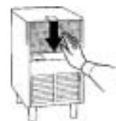
Pass på at viftemotoren ikke suger inn støv etc. i forbindelse med at gulvet inntil maskinen rengjøres.
