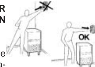
La boîte électrique de coupure doit être placée à proximité de la machine.
