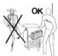
Lyft ismaskinen om den behöver flyttas så att benen inte skadas.
