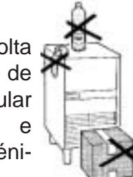
Não ponha em cima ou à volta da máquina qualquer espécie de material, que pode estrangular uma ventilação adequada e ameaçar as condições higiénicas.
