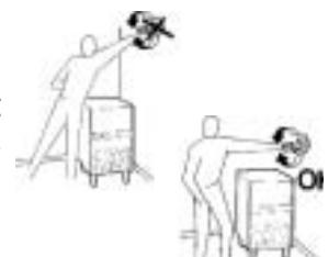
De water-toevoerkraan dient binnen handbereik bij de te installeren machine te zijn.
