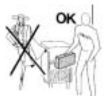
Se a unidade tiver que ser deslocada levante-a para não danificar as pernas.
