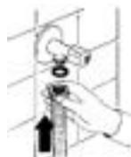
O esgoto é ligado e devidamente montado utilizando uma mangueira espiralada com um descaimento mínimo de 3 cm por metro.
