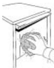
Gebruik voor het reinigen van de buitenzijde van de machine een zachte doek met een schoonmaakmiddel-oplossing, die speciaal geschikt is voor roestvrijstaal.
