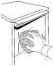
Para la limpieza del mueble es suficiente utilizar un trapo humedo con un producto específico sin cloro para acero inoxidable.
